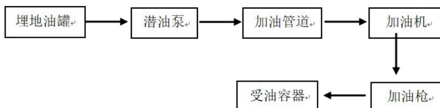
汽油加油机加油工艺框图如下：
